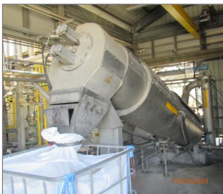
ภาพถ่ายที่ 2.2.1-19 เครื่องรีดตะกอน (Sludge Press)
